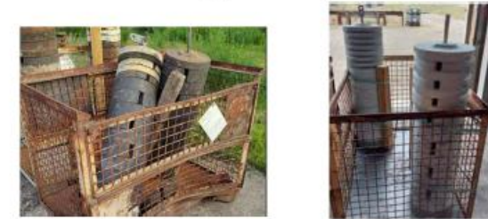
Salettes démontées, sablées HP, traitées anti-corrosion, remontées sur nouvelles tiges à tenon
